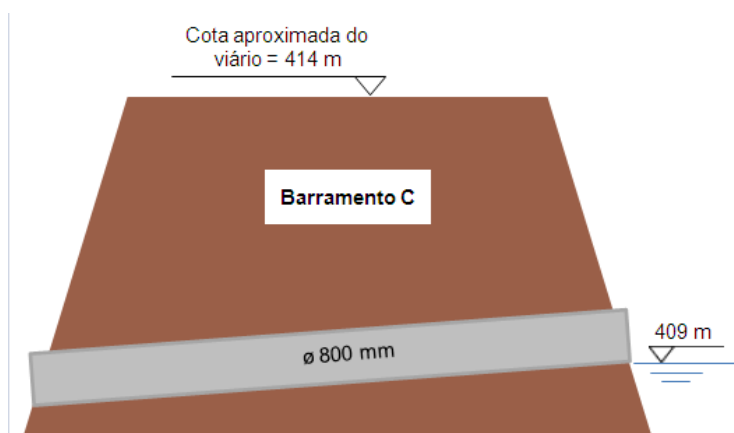
Figura 4.2.3.7.1-3: Croqui do barramento C, representação da tubulação de 800 mm de diâmetro adotada e cota aproximada do viário. Fonte: Geasanevita.
