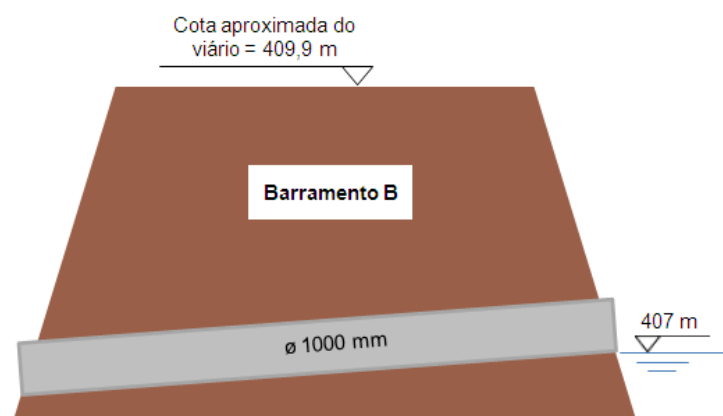
Figura 4.2.3.7.1-2: Croqui do barramento B, representação da tubulação de 1000 mm de diâmetro adotada e cota aproximada do viário. Fonte: Geasanevita.
